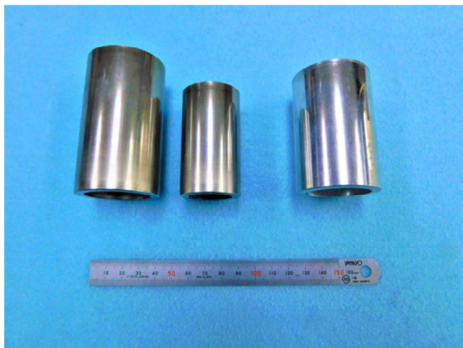
板厚0.2mmの深絞り ステンレス・アルミニウム等
