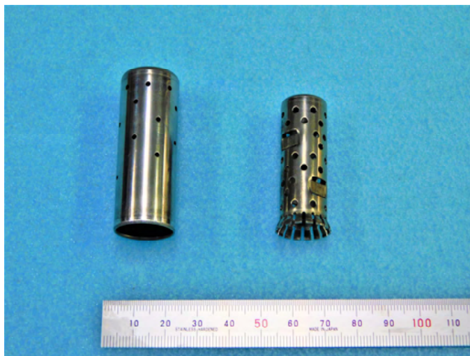
从拉深光圈到侧面钻孔 连续做到自动冲压一致性
