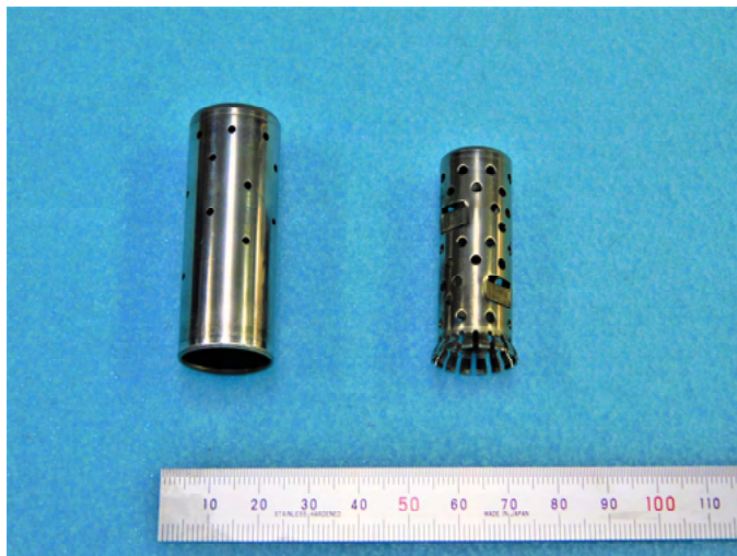
深絞りから横穴開けまで トランスファープレスで一貫加工
